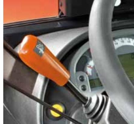
Con l'inversore idraulico SAME offre un'importante innovazione tecnologica: il sistema STOP&GO. Tale dispositivo, amplia le caratteristiche e le potenzialità dell'inversore, offrendo all'operatore un livello di manovrabilità superiore, soprattutto quando è necessario sospendere la marcia del trattore per intervalli di tempo non costanti, come ad esempio nelle operazioni con pala
