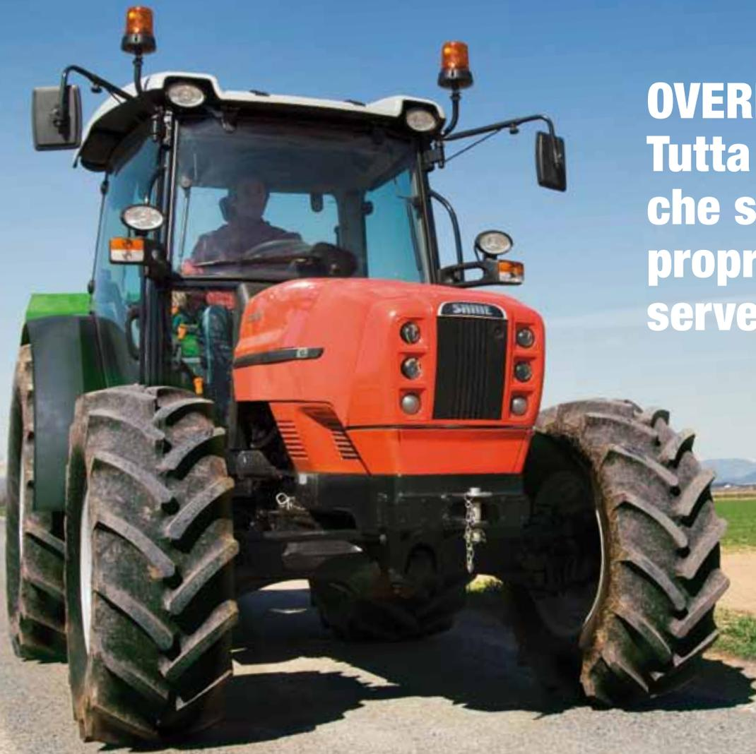
Insieme al regolatore elettronico il Dorado<sup>3</sup> 90 offre anche l'OVERBOOST, un innovativo sistema a controllo elettronico che, in caso di necessità, consente al motore di incrementare le sue prestazioni per un lasso di tempo utile a superare particolari circostanze in cui è richiesta una maggiore erogazione di potenza e coppia.
