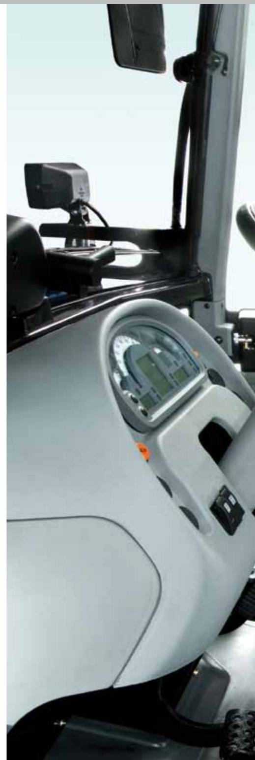
ampio spazio per ogni movimento. La comodità della piattaforma piana sospesa su silentblock, i pedali sospesi per frizione e freni a comando idrostatico e le leve cambio laterali, alleviano ulteriormente la fatica, così come la disposizione dei comandi nella comoda consolle alla destra del conducente.
