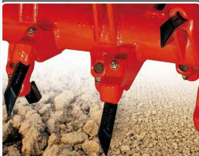
Rotore studiato per terreni molto sassosi. La struttura dei coltelli e la distanza tra gli stessi garantisce una omogenea preparazione del terreno permettendo un fluido deflusso di sassi e pietre.
